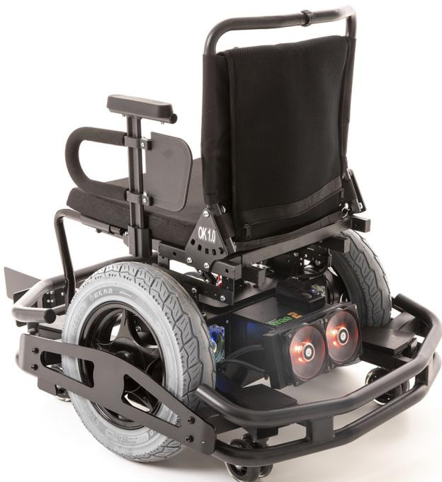
Dal punto di vista dinamico il telaio in acciaio è stato disegnato per ottenere la maggior centralizzazione possibile delle masse, i motori a trasmissione ad ingranaggi oltre a consentire il posizionamento degli stessi proprio al centro dell'asse di rotazione laterale della carrozzina garantiscono anche una efficienza superiore rispetto ai tradizionali con trasmissione ingranaggio-vite senza fine, le ruote con cerchi da 10" e campanatura di 8° presentano un
